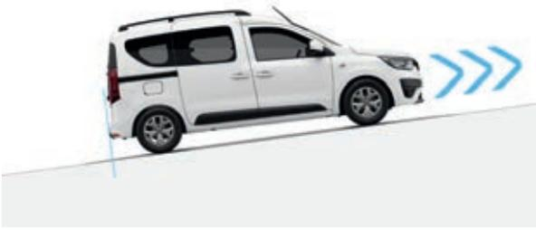
**yokuş kalkış desteği**, ESC ile birlikte, otomatik olarak fren basıncını 2 saniye koruyarak ayağınızı fren pedalından kaldırarak gaza basmanız için size zaman kazandırır. eğim %3'ü aştığında sistem etkin hâle gelir.
